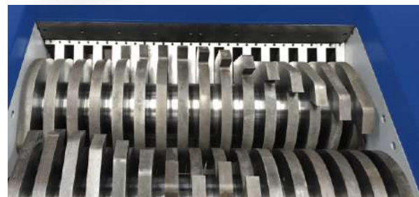
双轴机刀体（标配），刀片厚度可选。 Standard rotor whose knife thickness is customizable.
