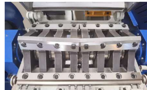
外置轴承允许带水破碎。 Outbound bearing allows wet granulation.
