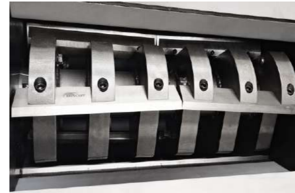
V型刀（标配），适用于各种塑料成型制品。 V rotor (standard), applicable for general plastic waste. 动刀和定刀采用D2合金。 Rotary and counter knife adopts D2 steel.
